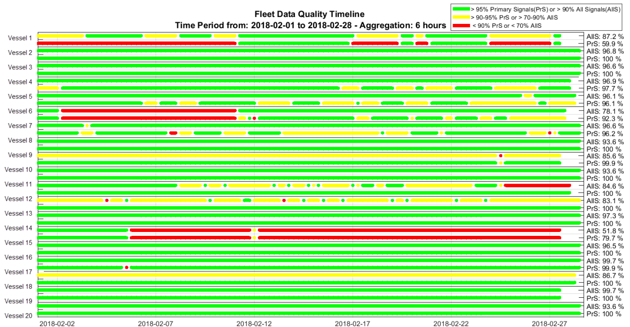
Abbildung 1: Die Fleet Data Quality Timeline zeigt für 20 Schiffe die jeweilige Datenqualität aller Signale sowie gesondert die der Primärsignale. Eine rote Einfärbung der Primärsignale deutet beispielsweise auf eine Auffälligkeit eines Messgerätes hin.
